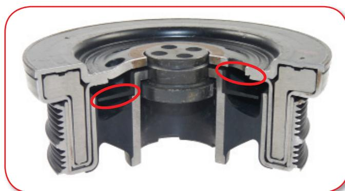
Photo 1: Amortisseur de vibrations de torsion avec écran thermique
